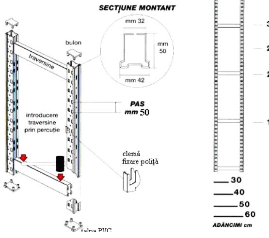
Traversele se monteaza prin percutie conform schitei de mai jos. Se fixeaza mai intai traversa inferioara si se continua in ordine pana la ultima traversa.
